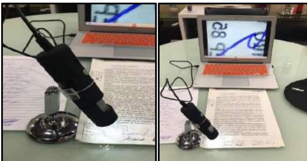
Figura 3: Mini Microscópio Utilizado nas análises das assinaturas.
