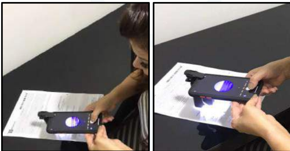
Figura 5: Microscópio Digital com captura para tela de celular.
