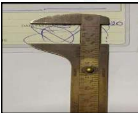
Figura 10: Paquímetro (utilizado para medição do calibre da letra).
